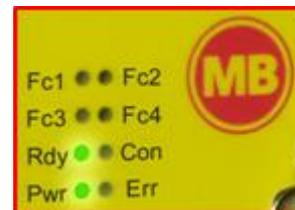
3. Drücken Sie nun die **'Dial Out'** Taste mit Hilfe eines schmalen, spitzen Werkzeugs (z. B. Kugelschreiberspitze) und halten Sie diese gedrückt, bis die LED 'Fc4' (TxD2) leuchtet.
